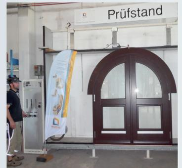
Unser eigener Fensterprüfstand gewährleistet einen hohen Anspruch bei gleichbleibender Qualität. Geprüft wird u. A.: Schlagregendichtheit, Fugendurchlässigkeit, Einbruchsicherheit etc.
